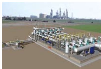
图1 Daniel计量橇设计软件创建的计量站橇座的三维图像
